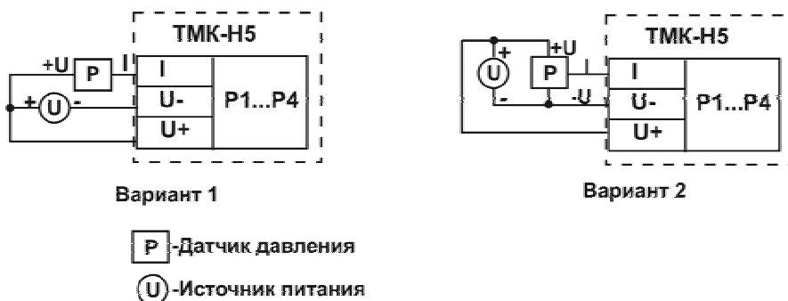
Рисунок Г.4 - Схема подключения преобразователей давления к TMK-H5
