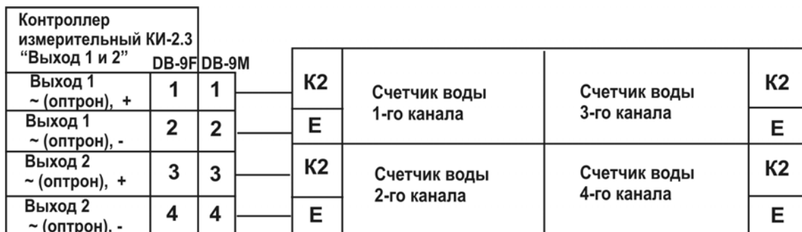
Рисунок Е.2 - Схема подключения вычислителя ТМК-N5 к контроллеру измерительному KI-2.3 при использовании в качестве преобразователей расхода счетчиков воды
